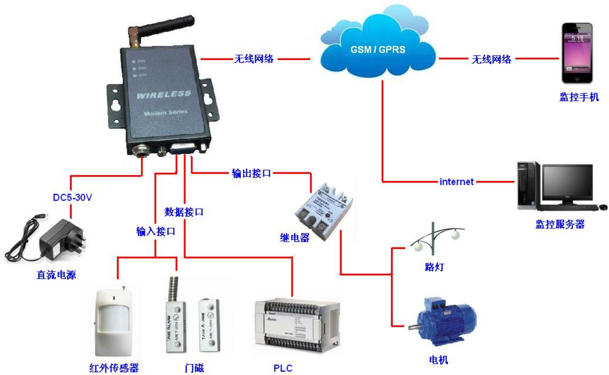
R-X01用于机房报警系统的构成示例
