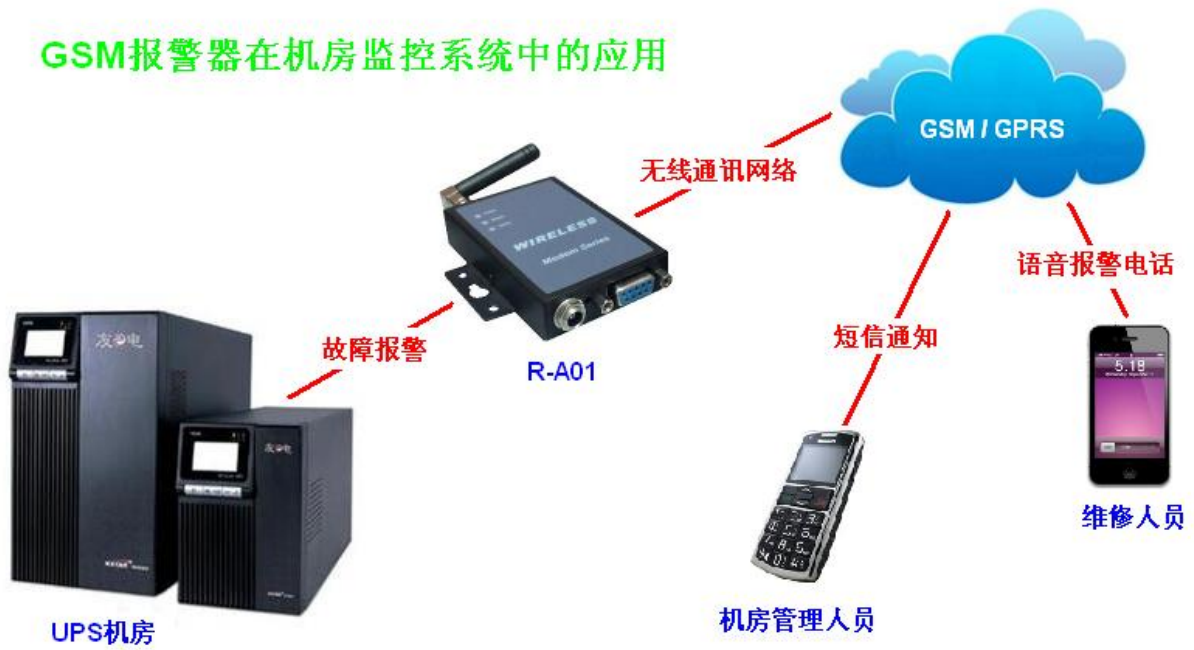
R-X01用于机房报警系统的构成示例
